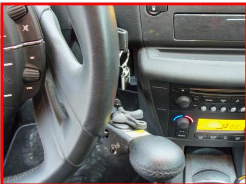
L'enfoncement de la pédale d'accélérateur est proportionnel à la pression que l'on effectue sur la gâchette, l'électronique filtre les à-coups et gère la progressivité.
