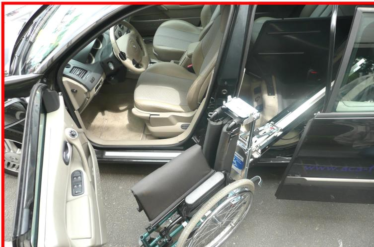
Système entièrement automatique d'ouverture de la porte arrière gauche avec chargement du fauteuil roulant manuel pliant. Commandé par un simple interrupteur au tableau de bord.
