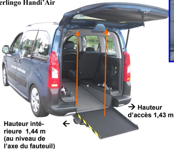
➤ Décaissement d'1,26 m de long avec revêtement antidérapant et insonorisant.
